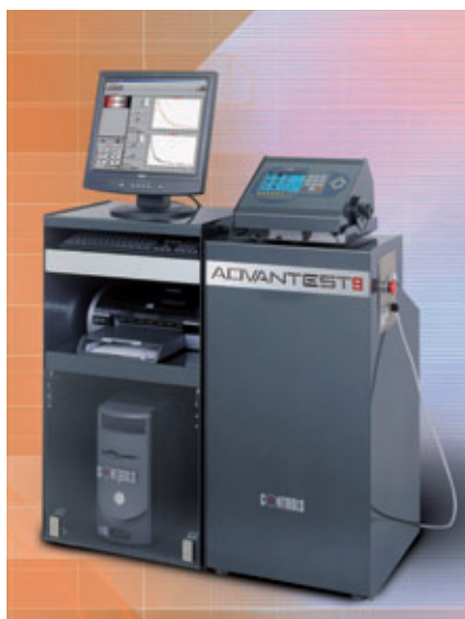
Fig. 2: 50-C9842 ADVANTEST 9 servo-hidráulica de alta sensibilidad unidad de control de
