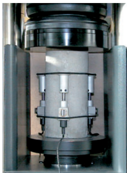
Fig. 1: Muestras de hormigón y mortero equipados con sensores de alta precisión 55-C0222/F para el ensayo de ME
