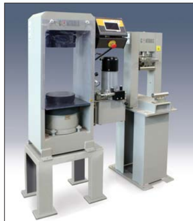
50-C4444 PILOT4 montada sobre pedestal (no incluido), con válvula 50-Q0004/UP1 para controlar el bastidor de flexión 50-C0900/FR.
